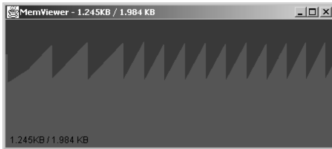
Abbildung 4.4: Typisches Sägezahnmuster des belegten Heap-Speichers
