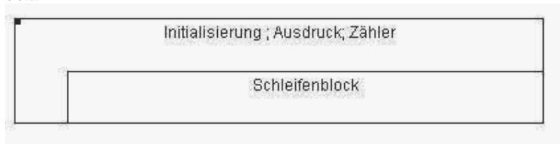
Abb. 8.6: Struktogramm für For-Schleife (Zählschleife)
