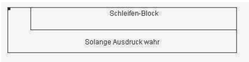
Abb.8.5: Struktogramm für Do-Schleife (Prüfung am Ende)
