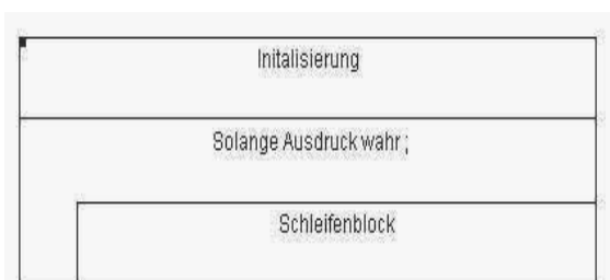
Abb.9.3: Einige Sinnbilder nach DIN 66261 (Struktogramme)
