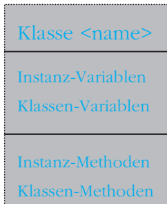
Abb. 11.1: Darstellung von Aufbau und Inhalt einer Klasse als UML-Diagramm
